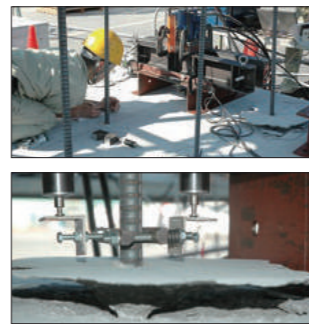
■引張試験状況 (財団法人 日本建築総合試験所)
